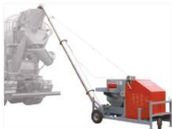
اضافه نمودن الیاف در مرحله آخر پس از اختلاط تمام اجزای تشکیل دهنده بتن
